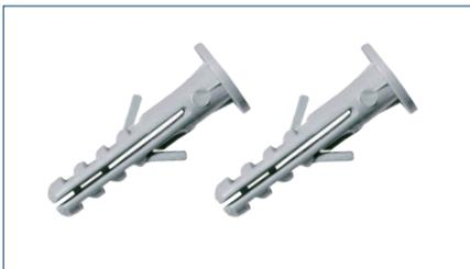
Se introduce en una perforación hecha en ladrillo o concreto y a la entrada del tornillo en la parte superior empuja las paredes del tarugo y comprime el plástico dentro del hueco ejerciendo presión.
