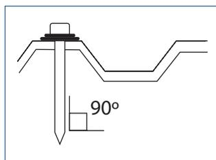
Los tornillos deben ser atornillados perpendicularmente respecto a las planchas.
