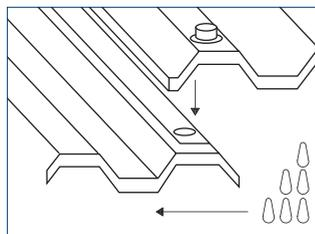
Instalar planchas contra la dirección del viento y lluvia. En los traslapos fije cada 200 mm o 300 mm aproximadamente.
