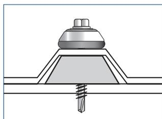
Fije las láminas colocando tornillos en la cresta de las planchas (parte más alta).
