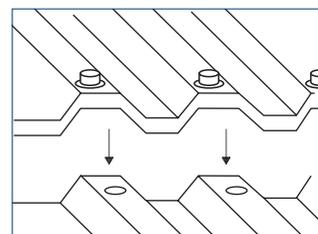
Fije los tornillos de juntura a una distancia de 30 mm entre cada uno, a lo ancho de la plancha.
