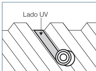
Instale las láminas con el lado UV hacia arriba y una vez instaladas quite las cintas y las etiquetas.
