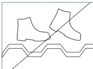
No camine de manera directa sobre las láminas antes o después de la instalación.
