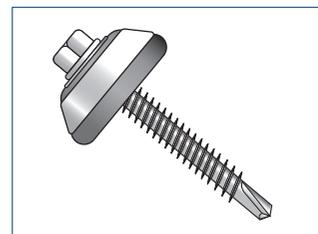
Utilice tornillos de 2" para la instalación. Se recomienda el uso de arandelas (golillas) de EPDM de 25 mm de diámetro.
