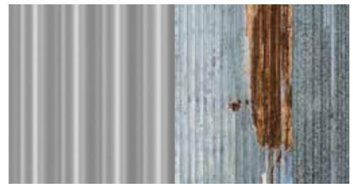
Comparación polycarbonato no traslúcido vs plancha de zinc.
