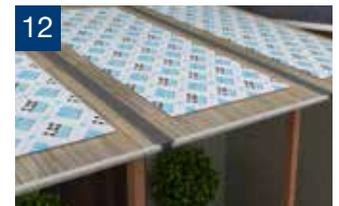
Continúe agregando secuencialmente: Un perfil base, una plancha y una tapa, hasta llegar al final de la estructura.
