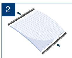
2 Instale a presión los perfiles de inicio y término en la plancha de policarbonato alveolar.
