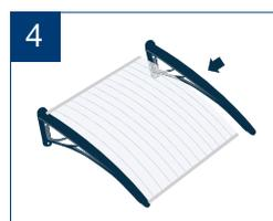
4 Fije el otro extremo de la plancha en el segundo soporte, use los tarugos y tornillos correspondientes.
