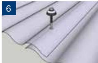
6 Para unión de planchas en el ancho, atornille en el lugar donde se superponen ambos elementos.
