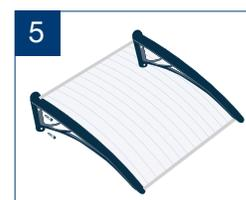
5 Finalmente fije el segundo soporte al muro, utilizando los pernos de anclaje incluidos en el Kit.
