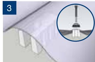
3 Fije la plancha a la costanera, colocando los tornillos en la cresta de la onda. Utilice topes para plancha ondulada.
