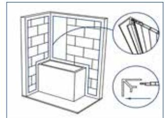
4- Comience instalando las tablas de izquierda a derecha. El lado macho de la primera tabla debe encajarse en el perfil puesto en el muro, de manera que el canto con la hembra del panel quede visible. La cara con diseño de la tabla debe quedar a la vista.
