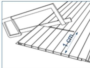
2- Una vez puestos los perfiles, mida la dimensión de largo de la tabla. Estas deben cortarse 5 mm menor al tamaño total, para permitir la dilatación del PVC provocada por los cambios de temperatura.
