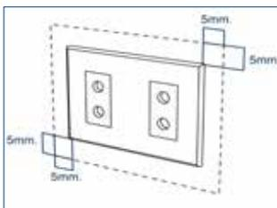
5- Considere una holgura de 5 mm mayor en la perforación del panel para cajas eléctricas o insertos, para permitir la dilatación del revestimiento de PVC provocada por los cambios de temperatura.
