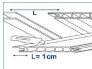
7- Cortar la tabla final de ancho igual a la dimensión total definida entre la hembra del panel anterior, y el fondo del perfil utilizado en el perímetro de la superficie a revestir.
