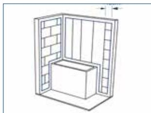
6- Continúe instalando las tablas hasta llegar a menos de 18 cm del perfil final de la superficie de muro.
