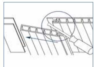
8- Inserte la tabla final en el perfil perimetral, y, con ayuda de un destornillador, haga palanca para encajar el macho de la tabla dentro de la hembra del panel anterior.
