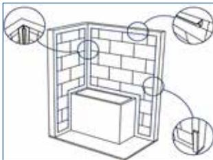
1- Instalar los perfiles, definidos según el punto B, por todo el perímetro de la superficie donde se aplicará el producto, cortando en 45° en los vértices. Los perfiles deben anclarse al muro mediante fijación mecánica y/o química, según el punto C.
