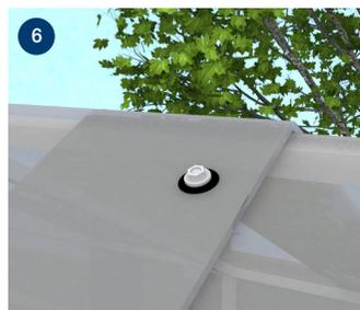
Fije las láminas a la estructura, utilizando tornillos auto perforantes o autorroscantes con golilla EPDM, según corresponda.
